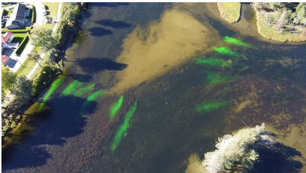
En av metodene som ble benyttet for å se hvordan kloramin fordeler seg i vannet var å bruke fargestoffet fluorescein, foto: Anders Gjørwad Hagen
