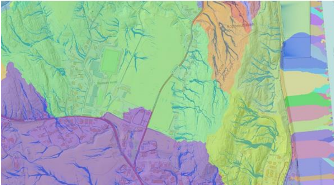
Figur 3-25 Multiflow avrenningsanalyse på DTM1 med angitt nedbørsfelt – Hvis detaljert hvor vann samler seg og renner i terrenget hvis det samles vann fra mer enn 200 kvadratmeter og opp til 10 000 kvadratmeter (som erfaringsmessig i Øvre Eiker er det arealt tilfang som skal til for at det oppstår skade, ref Frida). Over 10 000 kvadrat er markert i rødt (liten strekning i kopperudåsen og utenfor området/kommunen).
